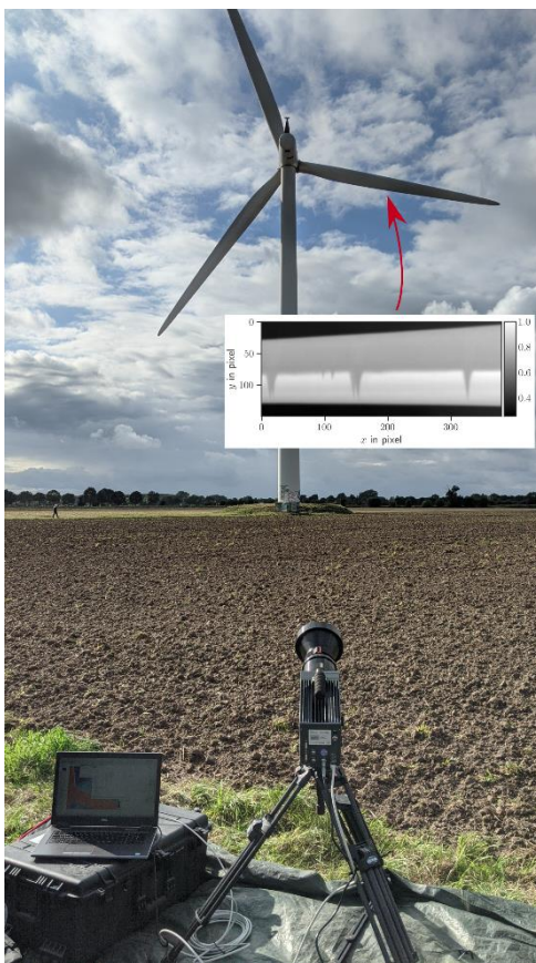
Bild 1: Thermographie-Messungen an Windenergieanlage in Thedinghausen mit thermografischem Ergebnisbild zur Strömungsvisualisierung.
